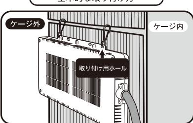
まず、本体側面の取り付け用ホールに付属の留め具を通してから、発熱プレートがケージの内側を向くよう設置位置を決めて、取り付けたい位置に合わせて最低2カ所、付属の留め具を取り付けホールに通して、ケージワイヤーに掛け固定して下さい。
