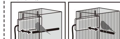
○ 図のように、止まり木がヒーター発熱面に触れないようにして下さい。
