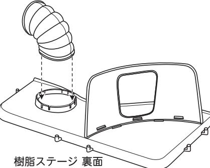
組み立てた樹脂ステージを表に返し「②ペーストレイ」に取り付けます。樹脂ステージの側面にある、取り付けフック(5箇所)をペーストレイの縁に開いている穴に差し込んで固定します。
