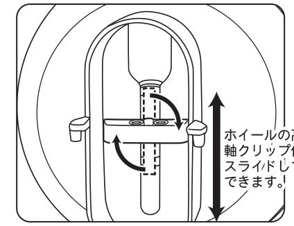
軸クリップのみをひねるように90度回転させて固定します。
